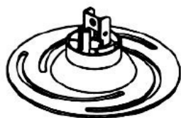
(1) Montažna plošča projektorja-a
